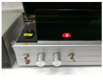
Mit dem Edelstein Spektrometer kann der langwellige ultraviolette UV-A Bereich und das durch einen UV-Laser ausgelöste Fluoreszenz-Spektrum untersucht werden, sowie das sichtbare VIS Farbspektrum und das nahe Infrarot N-IR Spektrum.
